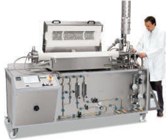
**HINGED TUBE FURNACE FOR HORIZONTAL OR VERTICAL OPERATION UP TO 1300°C - FOR GAS ATMOSPHERE OR VACUUM**
